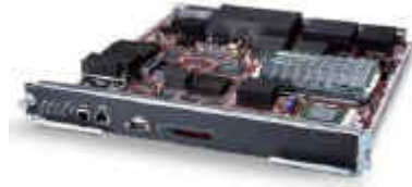
图 4 Cisco MDS 9500 系列 Supervisor 处理器模块
